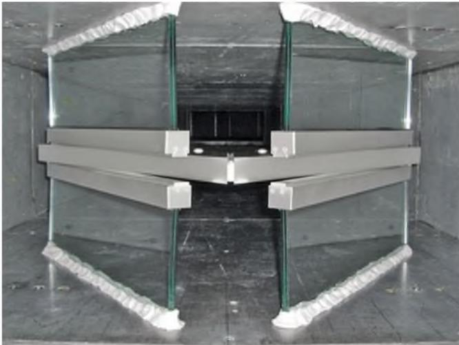
Bild 2. Ausschnitt eines in den Windkanal eingebauten Fassadenelements.
