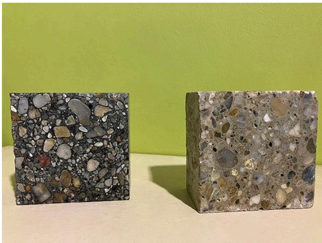
Beton mit (links) und ohne Pyrokohle: Ein Teil Pyrokohle reduziert drei Teile CO<sub>2</sub> des Gesamtprodukts.
