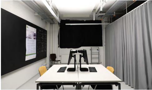
Bild 2: Messaufbau für einen Doppelarbeitsplatz mit einer eingeschalteten Bildschirmleuchte
